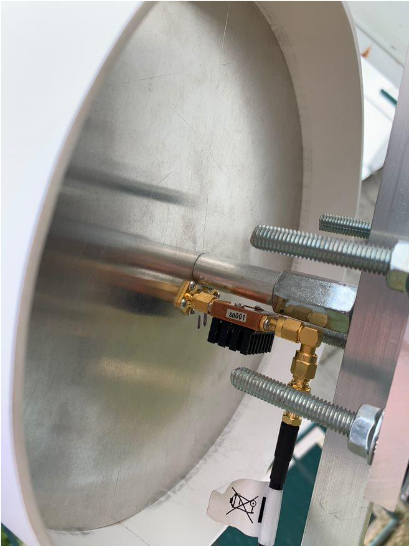
LNA AD61W à l'arrière d'une antenne
